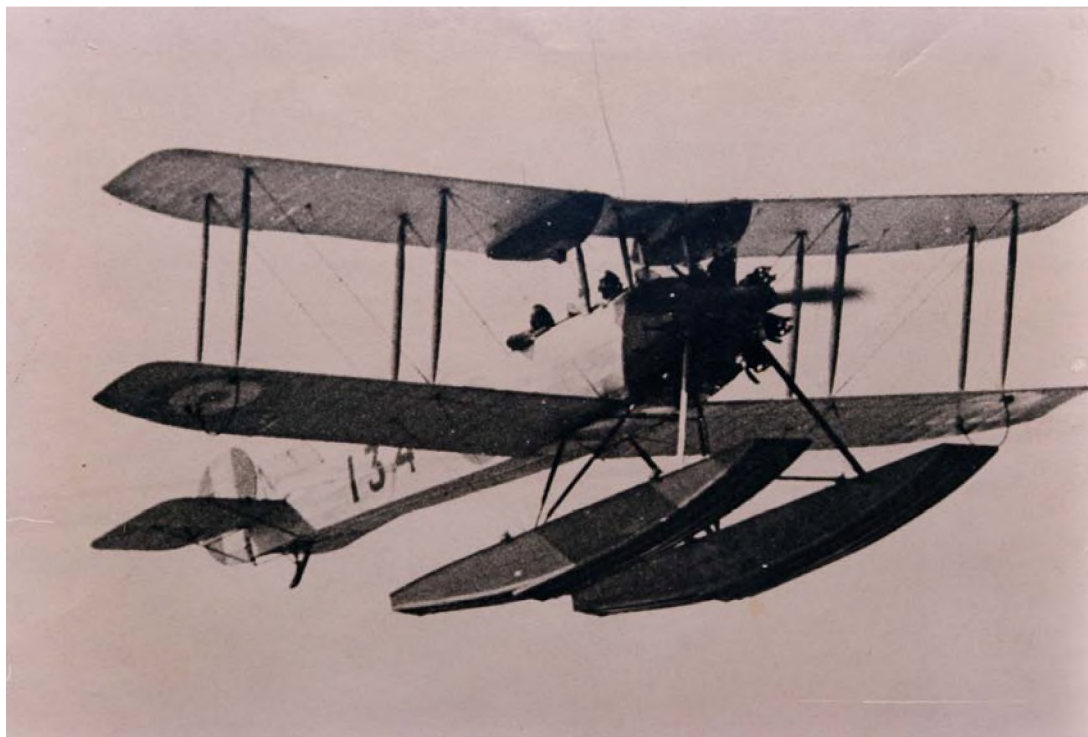
Φωτ. 38 - Υδροπλάνο Avro 504 O με πλωτήρες τύπου Edo, που κατασκευάζονταν στο ΕΑΦ.
