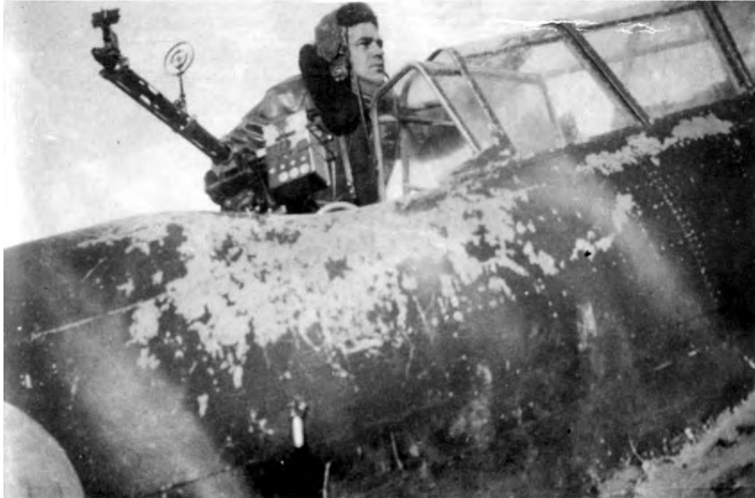
Φωτ. 52 - Ρο 63 τροποποιημένο με ελληνικής τοποθέτησης πολυβόλο FN
