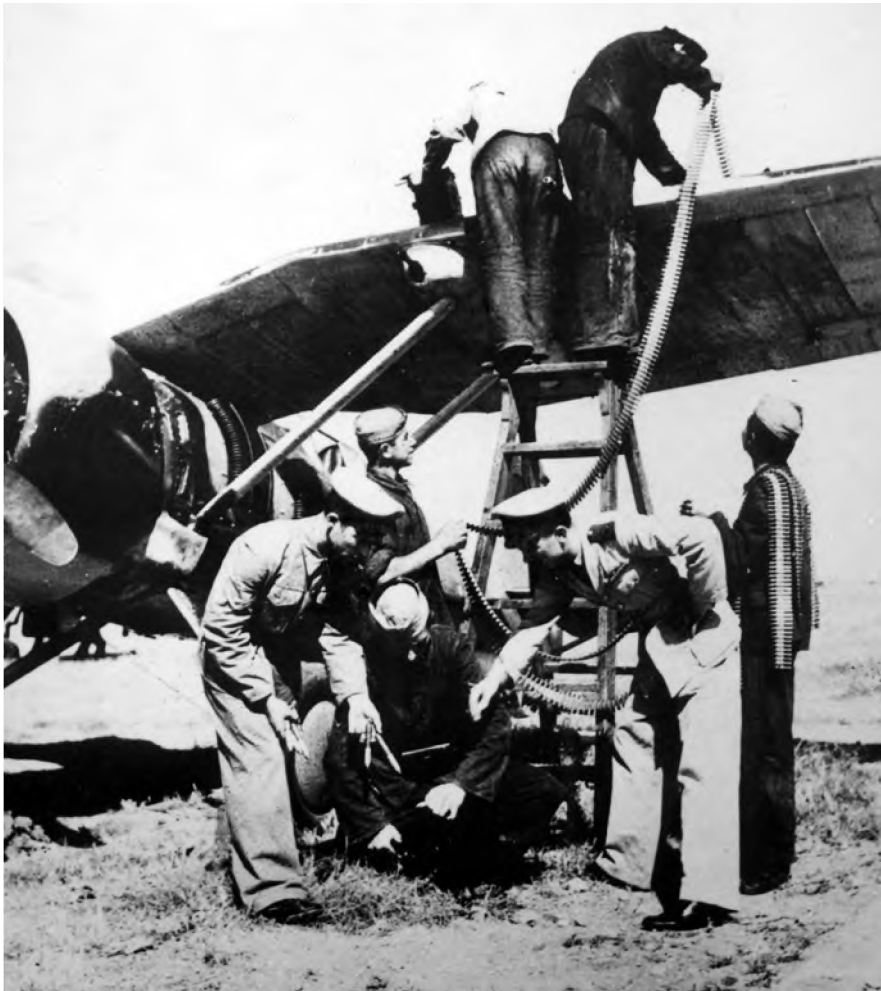
Φωτ. 54 - Στα χέρια του τεχνικού αριστερά διακρίνονται τα βλήματα 20 χιλ. για τα πυροβόλα Oerlikon FF του P.24.
