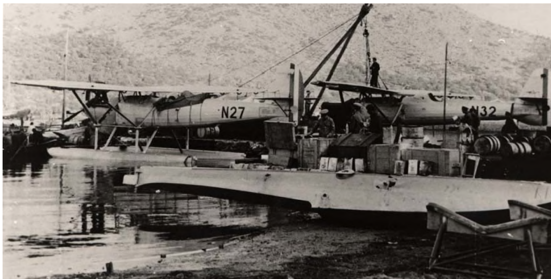
Φωτ. 50 - Do 22 υπό συντήρηση. Μέσα στους πλωτήρες που διακρίνονται υπήρχαν δεξαμενές καυσίμου από ελαστικό που είχαν αρχίσει να φθείρονται ένα χρόνο μετά την παράδοση τους, χωρίς να υπάρχει η δυνατότητα εντόπιας υποκατάστασης.
